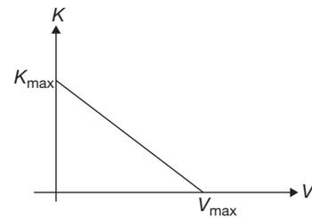
$$q_{\max} = \left( \frac{V_{\max}}{2} \right) \left( \frac{K_{\max}}{2} \right)$$
