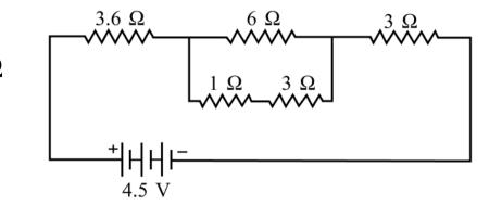
(ii) Equivalent resistance of total circuit is : (a) 5  $\Omega$  (b) 9  $\Omega$  (c) 11  $\Omega$  (d) 13  $\Omega$  $R_1 = R + 3.6 + 3$
