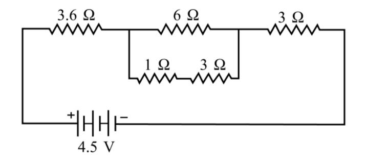
(i) Total resistance of parallel combination is : (a) 2.4  $\Omega$  (b) 3  $\Omega$  (c) 6  $\Omega$  (d) 2  $\Omega$
