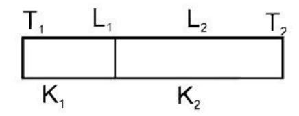
$$(A) \ \frac{(K_2L_2T_1+K_1L_1T_2)}{(K_1L_1+K_2L_2)} \ (B) \ \frac{(K_2L_1T_1+K_1L_2T_2)}{(K_2L_1+K_1L_2)} \ (C) \ \frac{(K_1L_2T_1+K_2L_1T_2)}{(K_1L_2+K_2L_1)} \ (D) \ \frac{(K_1L_1T_1+K_2L_2T_2)}{(K_1L_1+K_2L_2)}$$
