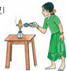
चित्र -13 : लौ परीक्षण करना
